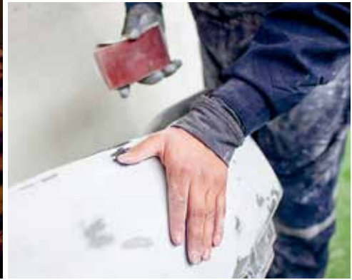
汽车面板先用腻子填充并仔细打磨，再用填料和底漆喷涂。
